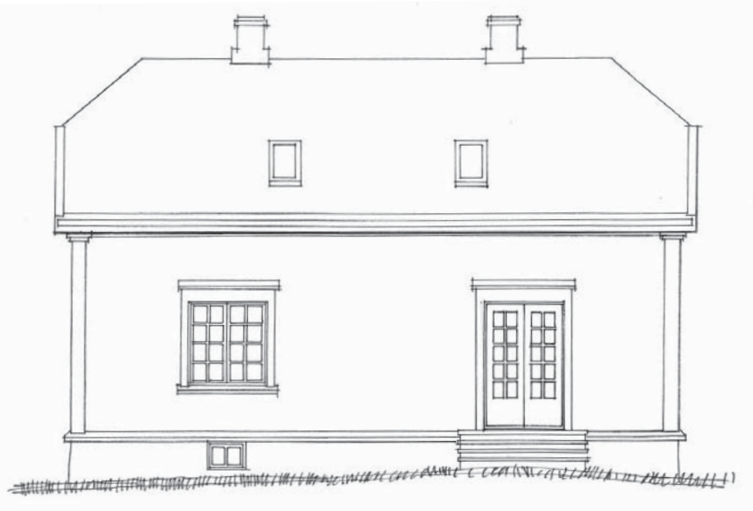
Ny terrassedør med samme plassering som vindu
